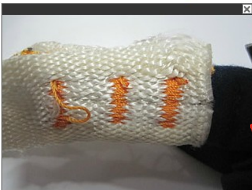
Absorbedor que presenta un inicio de deshilachamiento de la cinta a la altura de las costuras de seguridad y una costura con un bucle de hilo estirado (A Desechar)
