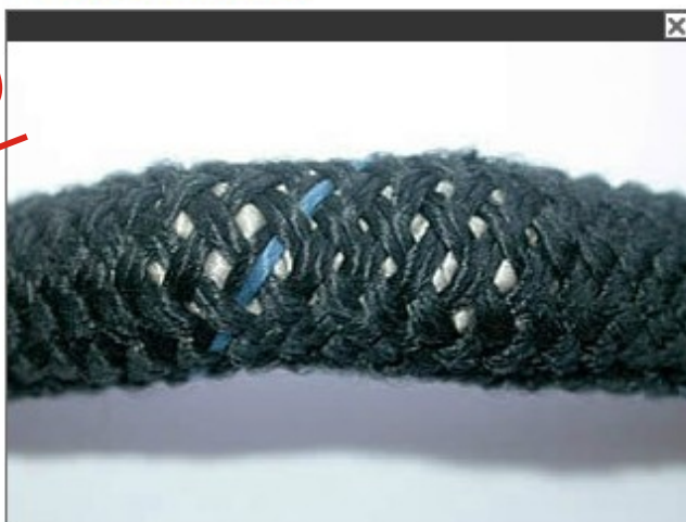
Hernia, alma de la cuerda muy deformada (A Desechar)
