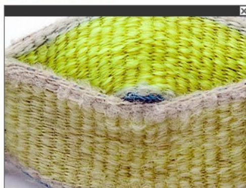
Exposición excesiva a los rayos UV (A Desechar)
