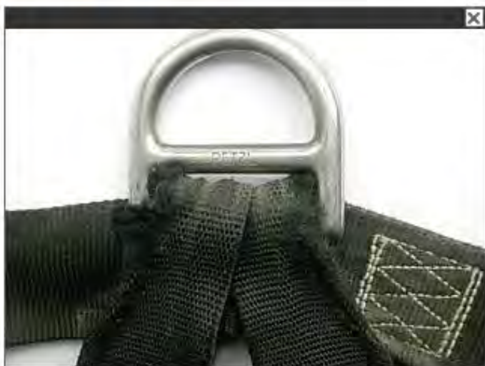
Principio de rotura en los bordes de la cinta a nivel del anillo de anclaje (A Desechar)
