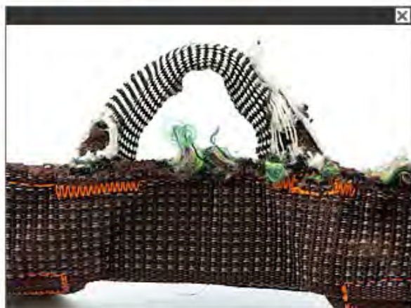
Desgaste general excesivo (A Desechar)
