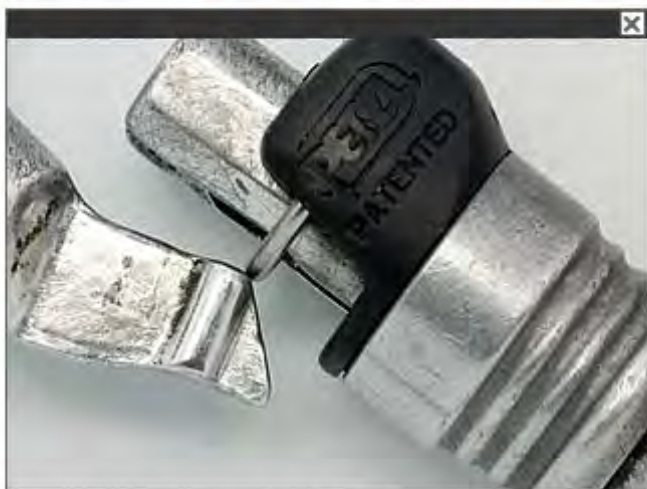
El gatillo del mosquetón no se cierra automáticamente (A Desechar)
