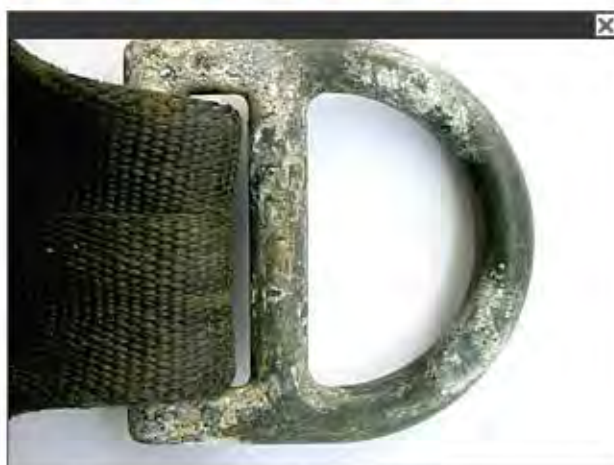
Oxidación del anillo de anclaje(A Vigilar) Debe desecharse si aparecen otros signos.
