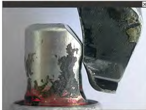
Gatillo y punta muy deteriorados y mala alineación gatillo-punta (A Desechar)
