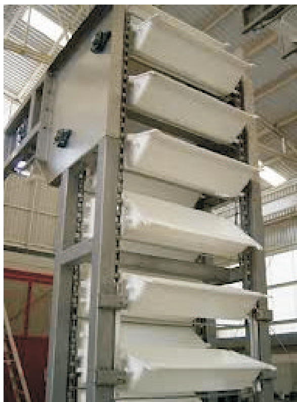
FIGURA 4. Elevador de cangilón con cazos plásticos.
