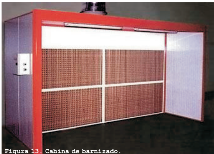
Figura 13. Cabina de barnizado.
